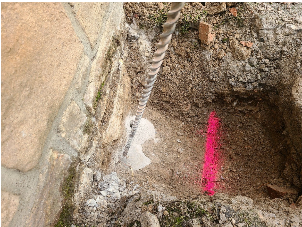
Sondage SM3 réalisé par perçage
